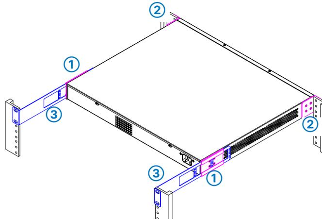
Beginnen Sie mit der Montage der beiden hinteren Führungen ①, indem Sie diese durch die vorgegebenen Bohrungen mit jeweils 4 der 16 beiliegenden Senkkopf-Befestigungsschrauben beidseitig hinten am Switch befestigen.
